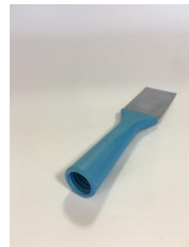
Conexión al cabo
